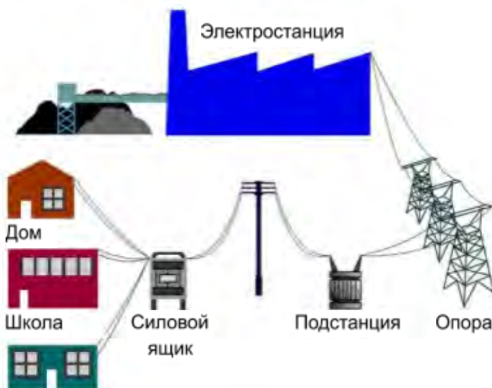
Передача энергии от электростанций к домам, школам и магазинам
