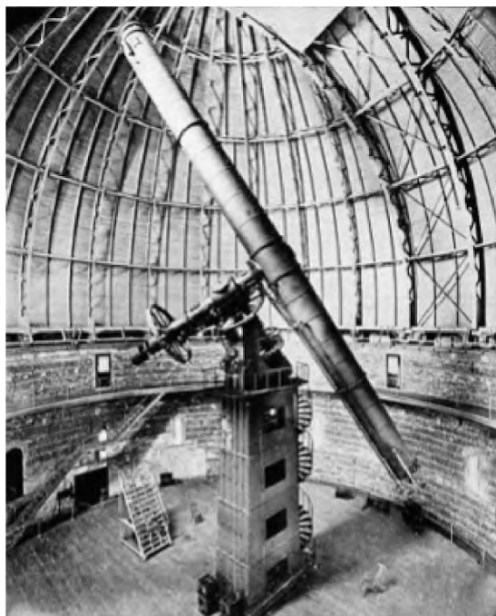
Самый большой рефракционный телескоп в мире находится в Йеркской обсерватории Чикагского университета в штате Висконсин. Он был построен в 1897 году. Его самый большой объектив имеет диаметр 102 см.
